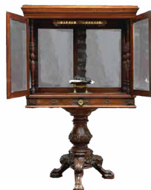
Máquina de Antonio Piaggio para desenrollar papiros.
